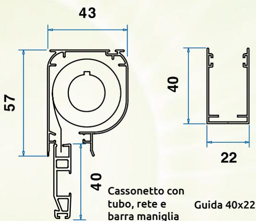
**Note:** \*secondo normativa europea, freno di serie per le zanzariere verticali con altezza maggiore di **180cm**. Larghezza massima per l'inserimento del freno nelle zanzariere verticali: **160cm**. Non è possibile utilizzare il freno nella zanzariera verticale se si utilizza già lo spazzolino antivento.
