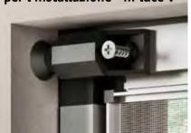
sistema di sospensione a staffe, il telaio -premontato- viene sospeso al serramento *esternamente* allo stesso (o, in alternativa, bloccato con dei fermi removibili nella luce del vano finestra, vedi immagini). Questo sistema comporta immediati vantaggi pratici per l'installatore e risolve eventuali limiti contrattuali al consumatore.
