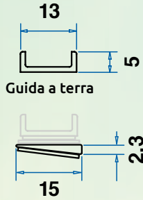
Sottoguida inclinata 7° per compensazione soglia (opzionale)
