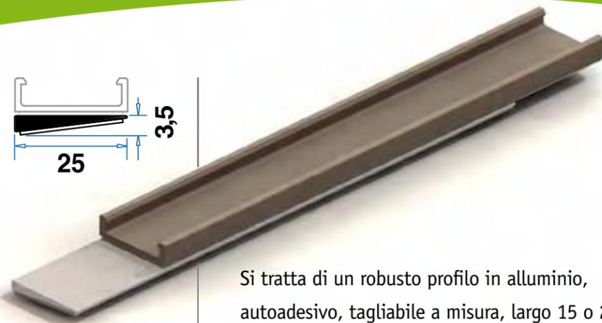
Si tratta di un robusto profilo in alluminio, autoadesivo, tagliabile a misura, largo 15 o 25 millimetri, sagomato con una sezione inclinata a 7 gradi o, meglio, CONTRO inclinata! Infatti va installato tra la guida bassa e la soglia avendo cura di posizionarlo in modo che la sua sagoma contrasti l'inclinazione della soglia riportando, di conseguenza, "in bolla" la base d'appoggio della guida. Soluzione veloce, pratica, economica e, soprattutto, efficace.
