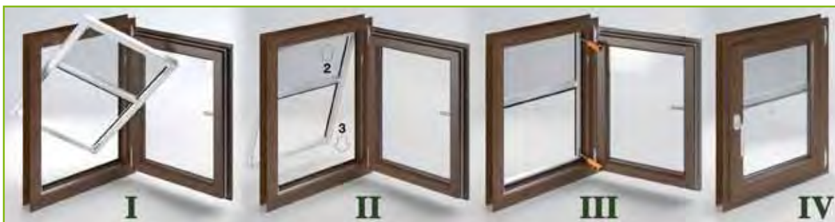
I. Inserire il telaio attraverso il serramento - II. Innestare i ferri a "Z" più lunghi in alto, poi quelli in basso - III. Fissare i ferri con le viti. - IV. FATTO!
